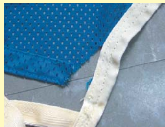
吊り具の一部が裂けている
