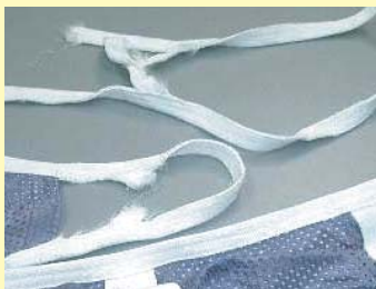
色落ちした繊維と劣化し裂けたストラップ
