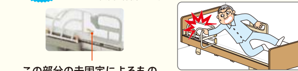
この部分の未固定によるもの
