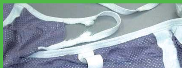
色落ちした繊維と劣化し裂けたストラップ
