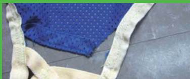
吊り具の一部が裂けている
