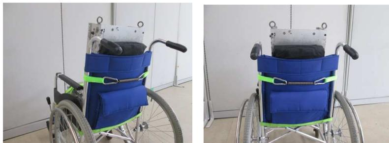
(6) ダミー大腿部は上下方向への動きに対しては自由度をもたせるため、帯状のゴム(又は布)と指定バネを組み合わせた拘束用ベルトを用いる。拘束用ベルトはバックサポートからダミー大腿部先端までの寸法の、ダミー大腿部先端から1/3の場所にセッティングし、位置が振動によりずれないように対策しても良い。また、ダミー大腿部が前後に移動して落下しないように、シートベルト(荷締めベルト等)をダミー大腿部前端とバックサポート間に巻き付ける。
