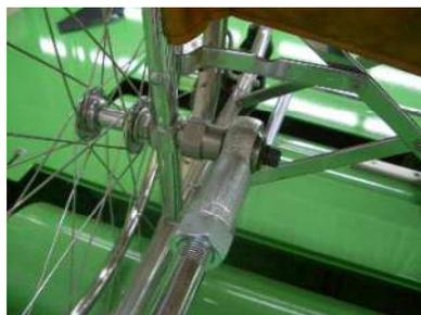
横ずれ防止用ボールジョイントは金属製を標準とし、上下及び左右方向への動きの自由度を妨げる構造であってはならない。
