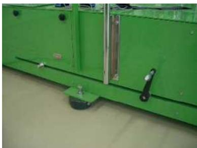
(10) キャスタが試験中に45度以上回転しないように、振れ止め治具を使用しても良い。
