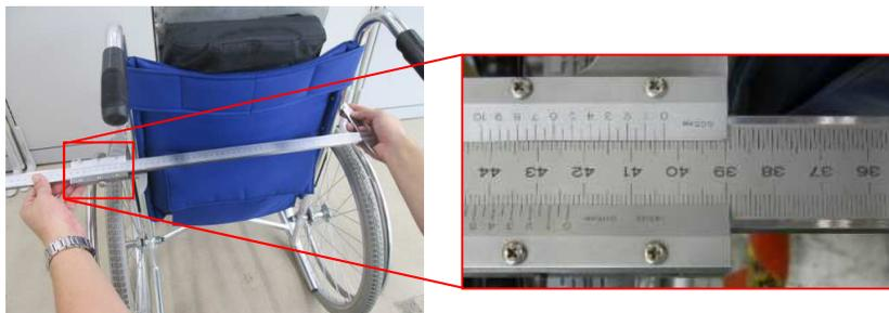
(5) 試験中に前方へ移動して落下しないように、ダミー胴部は拘束用ベルトを巻きつけ設定する。ダミー胴部での前後方向への動きに対しては自由度を持たせるため、帯状のゴム(又は布)と指定バネを組み合わせた拘束用ベルトを用いる。ダミー胴部の拘束用ベルトはバックサポート高さの1/3の場所にセッティングし、位置が振動によりずれないように対策しても良い。なお、拘束位置に背折れ金具があれば、直上で拘束しても良い。
