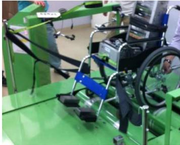
フロントパイプがない構造のものは、フレーム構造に影響を与えないようにベルトを設置する。
