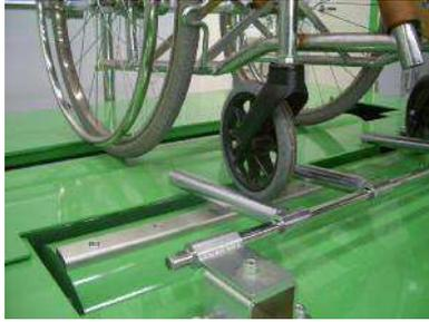
(11) 試験品の直進性が劣るものについては、ボールジョイントが装着されたアームのボールジョイント位置を前後調整し対応する。試験品が緊急時等左右方向へ移動しないようにするため、左右それぞれのフロントパイプと試験機側柱とをベルトにより保持させる。
