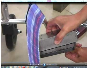
(8) 走行耐久試験機への車いす取り付け用治具を、試験装置側アーム端部にあるボールジョイントに挿入し、抜け防止用ボルトを締め付け、車いすが試験機上に固定されたことを確認する。なお、ボールジョイントを取付けたアームは水平な状態になるように試験機側の高さを調整する。
